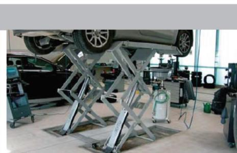
JUMBO LIFT NT 4000 – elevación de vehículo VW T5 con batalla corta y vehículos similares / instalación empotrada
